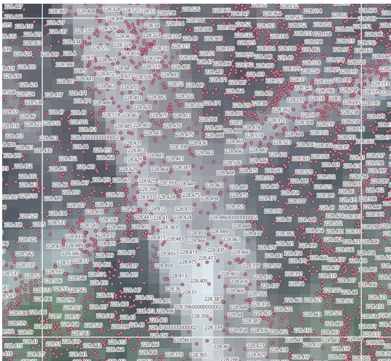
図一 点群から DTM の作成: メッシュは 50cm。各メッシュに含まれる点のうち、標高(数字)が最も低い点の値をそのメッシュの標高とする。
